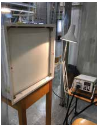
Det testade HEPA-filtret och en av de fotometrar som fanns tillhands i laboratoriet.
