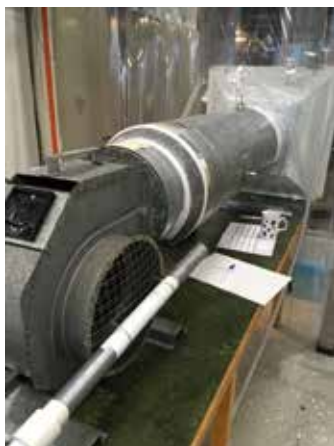
Den Fan-Filter-Unit (FFU) som användes för demonstrationslaboration och praktiskt prov.
