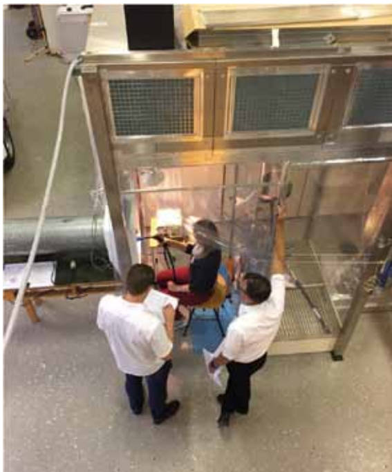
Från filterscanning test på CTCB-I Professional Level i testanläggningen på Chalmers Installationstekniska lab.
