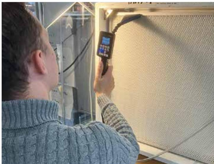
Bild 3. En kandidat testar ett HEPA-filter med fotometer.
