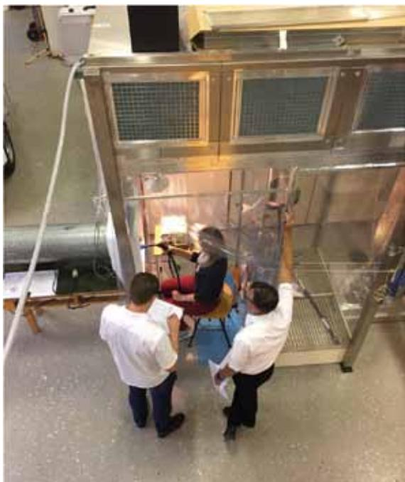
Från filterscanning test på CTCB-I Professional Level i testanläggningen på Chalmers Installationstekniska lab.
